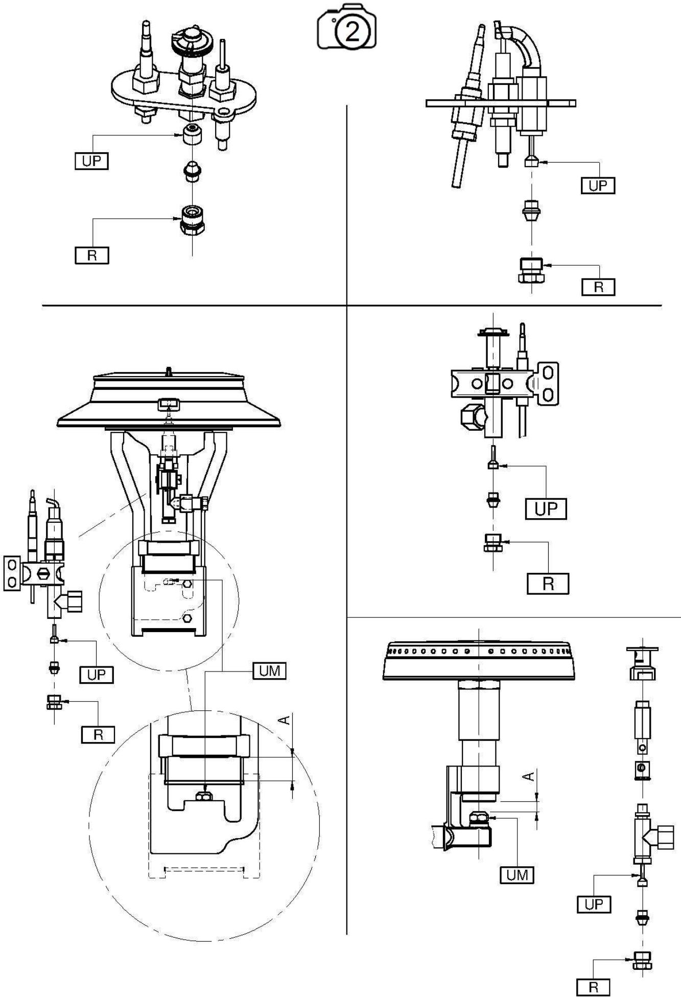
**VIII. TAB1 - DATI TECNICI - TECHNICAL DATA - TECHNISCHE DATEN - CARACTERISTIQUES TECHNIQUES - DATOS TECNICOS Ugelli e regolazioni - Dusen und Einstellungen - Nozzles and settings - Buses et les paramètres Boquillas y los ajustes - Nozzles en instellingen**
