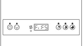
Waschgang fast (FS): erlaubt einen kürzeren Waschgang im Vergleich zum Standard; dabei gibt es einen höheren Wasserverbrauch beim ersten Waschgang.
