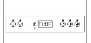
Wenn diese Option aktiviert ist, wird der Spülbehälter vollständig leergepumpt und anschließend bei jedem Spülzyklus mit sauberem Wasser gefüllt. Die Dauer dieses Vorgangs hängt von der Wasserzulauftemperatur ab.
