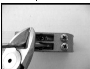
Drähte mithilfe von Zange und Schraubstock fest anziehen und Drähte in der Klemmplatte
