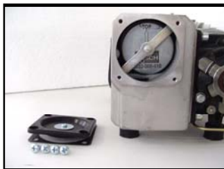
Der Filter ist zu sehen und ist befestigt hinter einem Spanner
