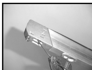
Drähte mithilfe von Zange und Schraubstock fest anziehen und Drähte in der Klemmplatte
